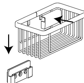
Ausrichten, Bohrlöcher markieren. Bohren und mit beigelegten Dübeln verschrauben. Korb einhängen, Blende aussetzen.
