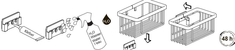
Power Kleber in mittlere Öffnung des Adapters drücken, bis er seitlich austritt. Mit reichlich Wasser besprühen.
