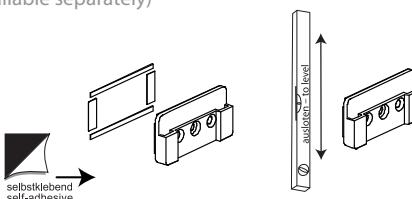
Oberfläche reinigen. Schutzfolie des doppelseitigen Klebebandes entfernen. Klebeadapter ausrichten und andrücken.
